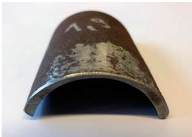
Durch Korrosion reduzierte Wandstärke eines Kesselrohres
